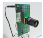
参考出展されたLYRA 3D (ToF) 従来比でフレームレートが4倍速の 高速測定向け
