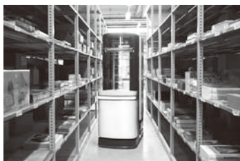
図4 ピッキング指示をワイヤレスで受信し、指定された棚に自動的に移動
