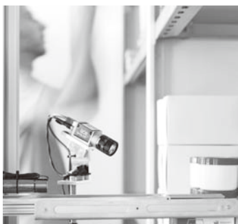
図2 曲がった本の正確な位置測定に威力を発揮するシート光技術
